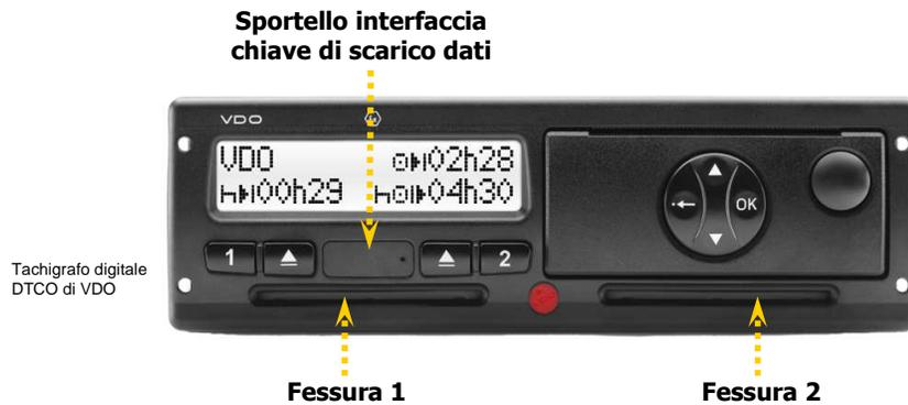
Trasferimento **Dati Tachigrafo** (file M\_) su chiave di scarico dati
